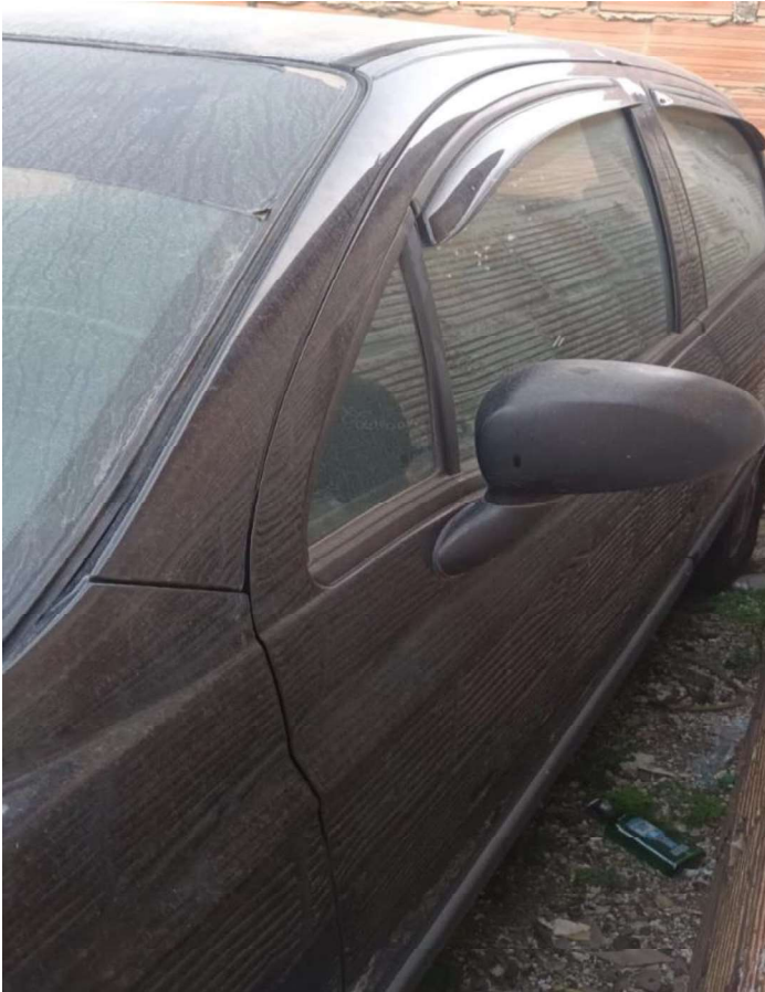
DETERIORO PINTURA POR EL SOL Y LA LLUVIA
