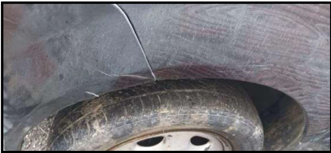
ESTADO DE LA PINTURA Y SUS DEFECTOS POR RAYONES EN LA MISMA
